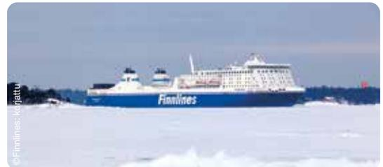
**Schiff:** Die baugleichen Fähren Finnstar, Finnmaid und Finnlady verkehren das ganze Jahr auf der Route zwischen Travemünde und Helsinki. Die zwischen 2005 und 2007 gebauten Schiffe verfügen über die höchste Finnische Eisklasse 1a Super.
